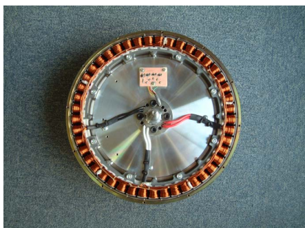
図 3 DC ブラシレス DD モータ Fig.3. DC brush-less DD motor
