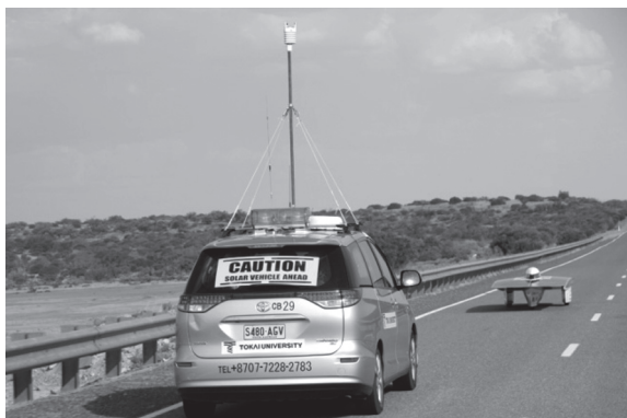
図 15 ルーフ上に気象センサ、警光灯、衛星通信アンテナ、全天日射量計などを備えたサポートカー
