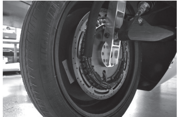
図10 低転がり抵抗タイヤを装着した高効率DDモータ
