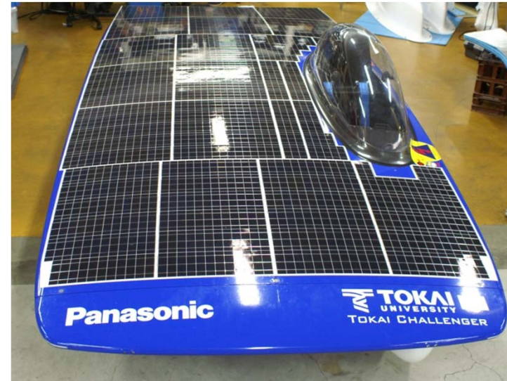
太陽電池モジュール
