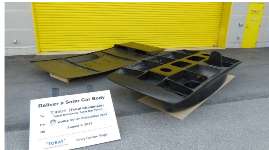
東レ・カーボンマジックによるボディ成形
